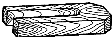
3. Прокладка для предохранения поршня от повреждений при снятии цилиндра
