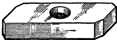
31. Подкладка для выпрессовки пальца из щеки коленчатого вала
